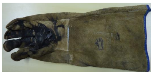
Figura 03 – Luva de raspa queimada no retrocesso de chama.
