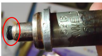
Figura 03 – Sede danificada do bico de corte.
