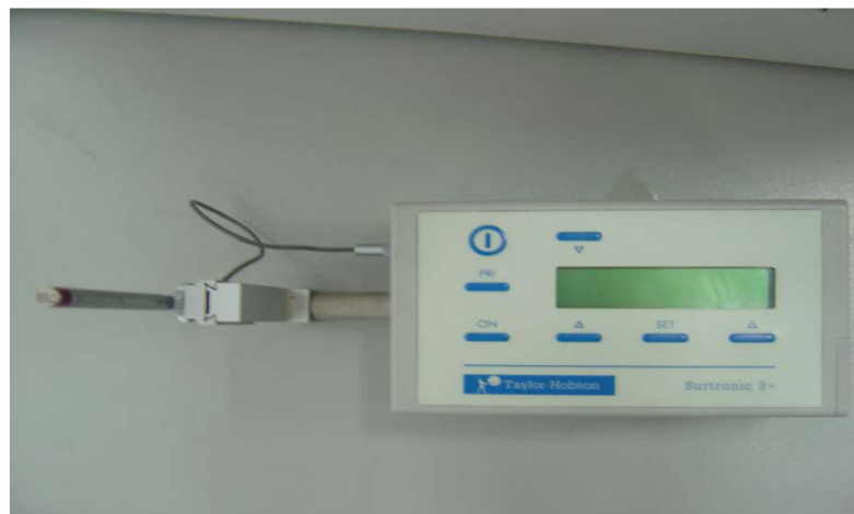
Figura 3.22- Rugosímetro utilizado na medição da rugosidade
