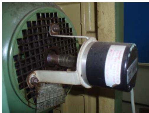
Figura 3.24 – Disposição da montagem do encoder acoplado ao eixo do motor da retificadora
