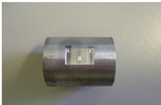
Figura 3.25 - Corpo de prova com a impressão do perfil do rebolo
