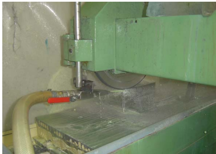
Figura 3.17 - Vista geral do sistema utilizado na retificação plana com detalhe para o posicionamento do bocal otimizado na operação retificação.
