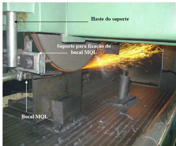
Figura 3.14 - Disposição geral do sistema rebolo/peça/bocal MQL e máquina empregados nos testes com a técnica MQL.
