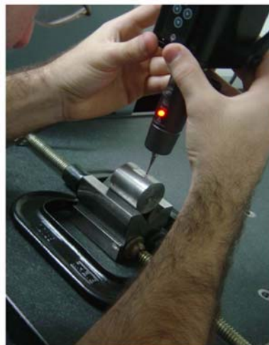
Figura 3.29 - O operador da máquina realizando a coleta dos pontos necessários para a formação dos planos auxiliares à medição do perfil de desgaste do rebolo impresso no corpo de prova.
