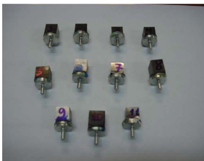
Figura 3.32 – Amostras prontas para análise no MEV
