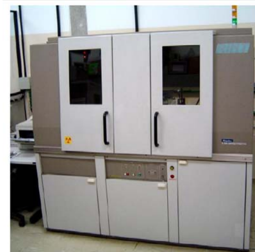
Figura 3.36 Difratorômetro de Raios-X, fabricante RIGAKU DMAX modelo Rnt2000 (FARIAS, 2009)
