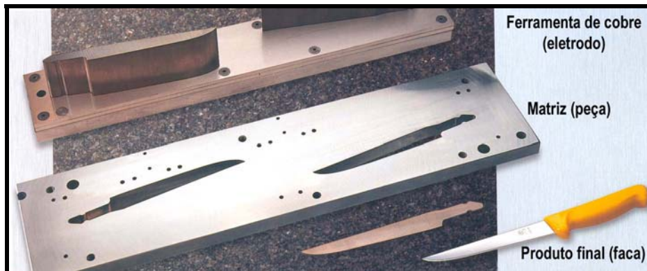
Figura 2.1 - Eletrodo-ferramenta de cobre, matriz e faca (CATÁLOGO TÉCNICO CHARMILLES).
