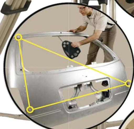
Também é possível eliminar dispositivos caros fixando os alvos diretamente na peça. O Dynamic Part Referencing mantém automaticamente o alinhamento da peça para que não haja necessidade de evitar o movimento da peça durante a medição com um dispositivo.
