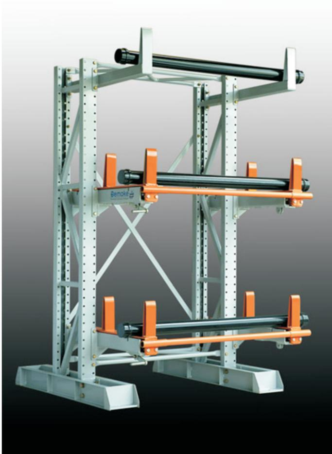
São estruturas de armazenagem para barras e perfis longos que necessitam de manuseio por meio de talhas e pontes rolantes. O sistema de gavetas permite deslocar os berços de apoio, permitindo acesso ao material sem o deslocamento do material do nível acima. Ideais para materiais que necessitam de proteção durante a movimentação: como barras retificadas, eixos de cilindro, perfis de plástico entre outros.
